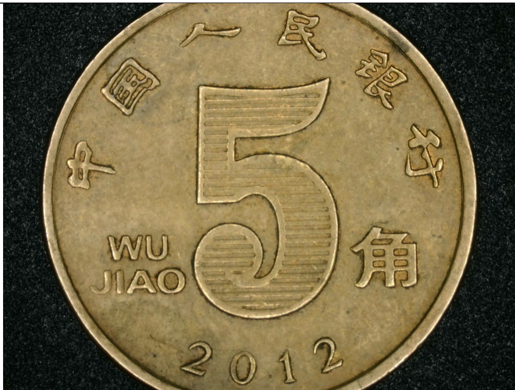
图 18 环形光照明情况下拍摄硬币图像 (ZM0480H1080PA)
