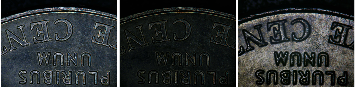
图 17 硬币在左) 普通环形光源；中) 偏振环形光源；右) 同轴照明光源照明下的拍摄效果
