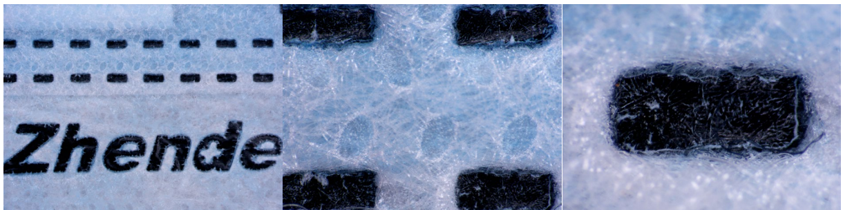
图 17 TZM0440-W3100-TV3050 拍摄的口罩织物图像 左) 0.4X 中) 2.0X 右) 4.0X
