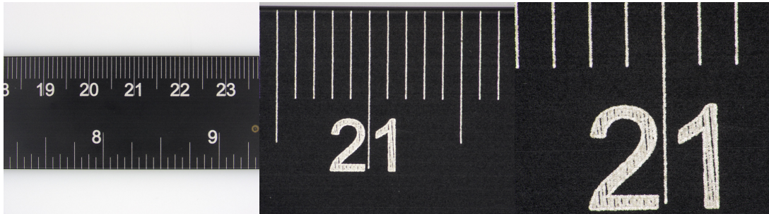
图 5 TZM015120-W4100-TV4100 搭配环形光源拍摄钢尺图像 左) 0.15X 中) 0.6X 右) 1.2X
