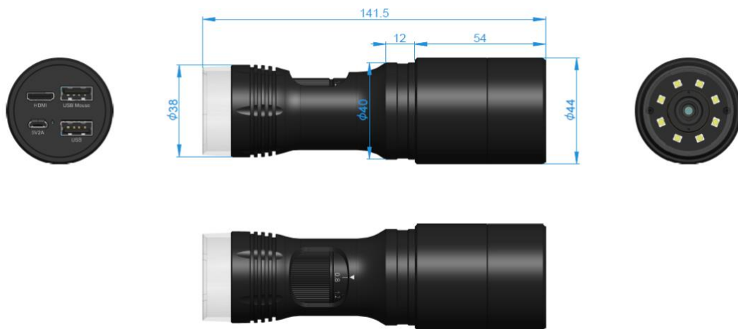
图 1 PZM0840H1080PA-EDRL 主机尺寸图
