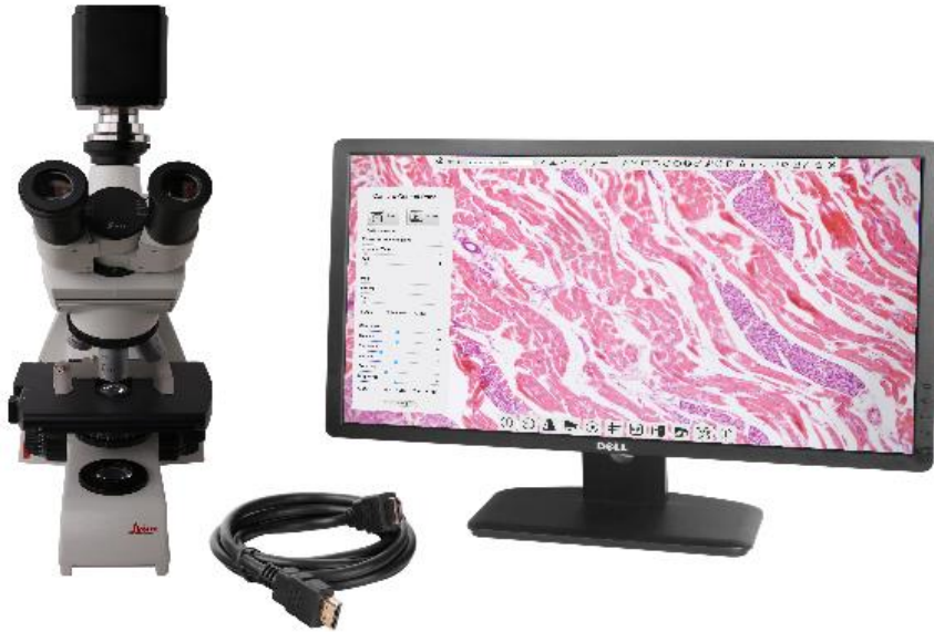
图 5 XFCAMTOP4K8MPA 相机通过 HDMI 线连接到 HDMI 接口显示器
