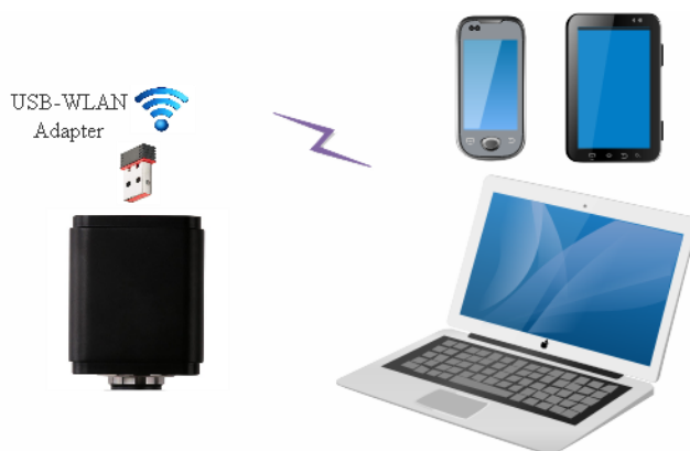
图 8 电脑或移动设备通过 WLAN 连接 XFCAMTOP4K8MPA 相机
