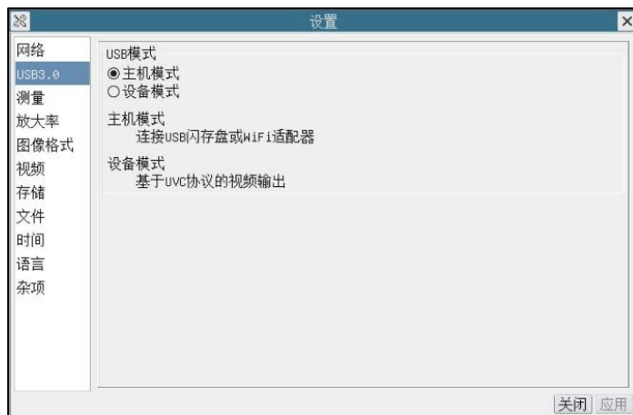
图 5 将 USB3.0 接口设置为主机模式
