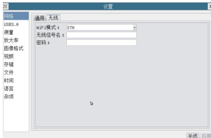
图 7 将相机的网络设置为无线 STA 模式
