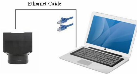
图 15 X7FCAM4K16MPA_EFL 系列相机通过 LAN 接口连接到电脑
