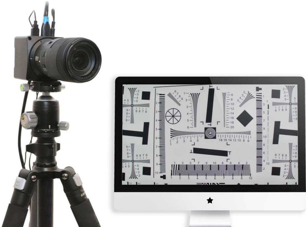
图 10 X7FCAM4K16MPA_EFL 相机+EF 卡口镜头，通过 HDMI 线连接到 HDMI 接口显示器
