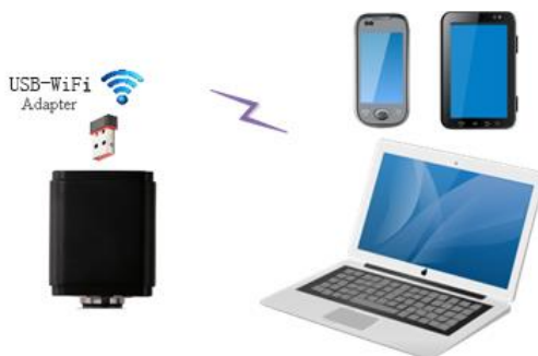
图 8 电脑或移动设备通过 WiFi 连接 X5FCAM4K8MPA 相机
