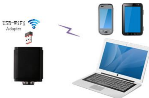
图 8 电脑或移动设备通过 WiFi 连接 X5CAM4K 系列相机
