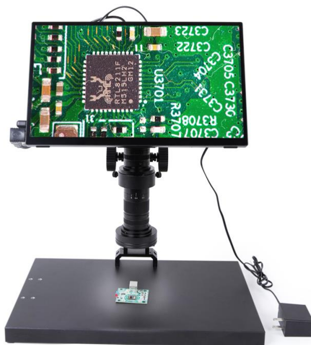
图 6 TPS-210A50 (支架)+TZM0480 (0.4X~8X 连续变倍单筒)+TXCAMLITE4K (带触摸功能 HDMI/USB 输出 CMOS 相机)+触摸屏, 触摸屏通过自带支架上的安装孔, 固定在相机前端固定块上(正面图, 可以用短的 HDMI 线与 USB Type A 转 Type C 数据线连接相机与触摸屏)
