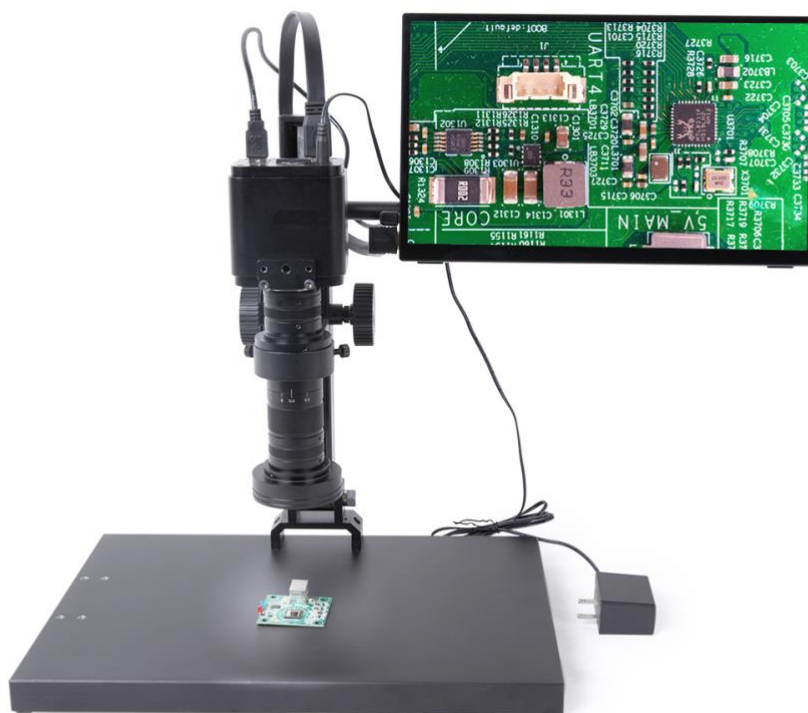
图 8 TPS-210A50 (支架)+TZM0480 (0.4X~8X 连续变倍单筒)+TXCAMLITE4K (带触摸功能 HDMI/USB 输出 CMOS 相机)+触摸屏, 触摸屏通过自带支架上的安装孔, 固定在支架的挂杆上(正面图, 可以用短的 HDMI 线与 USB Type A 转 Type C 数据线连接相机与触摸屏)
