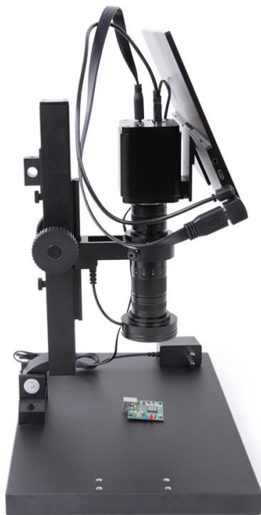
图 7 TPS-210A50-G (支架)+TZM0480 (0.4X~8X 连续变倍单筒)+TXCAMLITE4K (带触摸功能 HDMI/USB 输出 CMOS 相机)+触摸屏, 触摸屏通过自带支架上的安装孔, 固定在相机前端固定块上(左侧图, 可以用短的 HDMI 线与 USB Type A 转 Type C 数据线连接相机与触摸屏)
