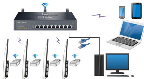
图 10 多台 AIOCAMTOP4K 系列一体相机通过 WiFi 连接到路由器
